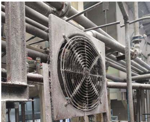
ภาพที่ 25 พัดลมระบายความร้อน
